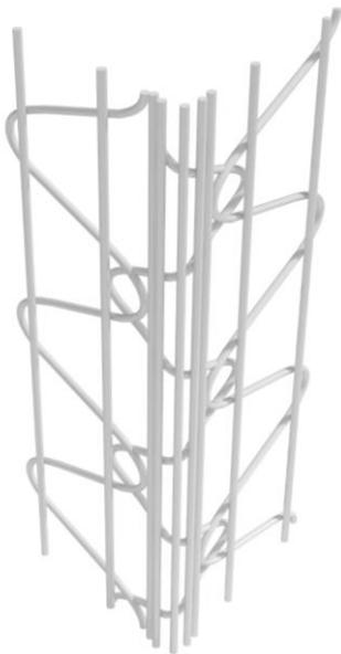
Der Drahrichtwinkel ist ein Winkel aus verzinktem Draht, der an diversen Stellen punktgeschweißt und miteinander verbunden ist. Durch die nur geringe Berührung der Drähte ermöglicht er eine hohe Putzdurchlässigkeit und eine optimale Armierung der Kanten. Somit lässt sich der Drahrichtwinkel vollständig mit dem Grundputz ausspritzen, ermöglicht einen maximalen Mörteldurchgriff und sorgt somit für eine hohe Stabilität an Ecken und Kanten.
