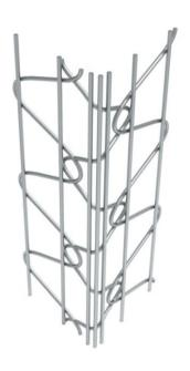
Der Drahtrichtwinkel ist ein Winkel aus Draht, der an diversen Stellen punktgeschweißt und miteinander verbunden ist. Durch die nur geringe Berührung der Drähte ermöglicht er eine hohe Putzdurchlässigkeit und eine optimale Armierung der Kanten. Somit lässt sich der Drahtrichtwinkel vollständig mit dem Grundputz ausspritzen, ermöglicht einen maximalen Mörteldurchgriff und sorgt somit für eine hohe Stabilität an Ecken und Kanten.
