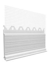
Durch das Aufstecken auf den Blechanschluss ergibt sich eine bewegliche und schlagregensichere Verbindung zwischen Blech und Putz im WDVS Bereich. Bewegungen des Blechs werden aufgenommen und somit Rissbildungen im Putz verhindert. Es entsteht eine gezielte Ableitung von Regenwasser und eine exakte und saubere Kantenausbildung.
