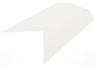
Die Armierungspfeile werden für Diagonalarmierung an Ecken von Fenster- und Türöffnungen vor dem Auftragen des Unterputzes angebracht. Sie beugen der Rissbildung im Eckbereich vor.
