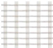
Das robuste Glasfasergewebe ist zur Einbettung in den Unterputz sowohl als Zusatzarmierung im Außenputz als auch zur Verbesserung der Druckfestigkeit in stoß- und schlaggefährdeten Bereichen bei Fassadendämmungen geeignet. Es ist auch bei sehr starken Rissbildungen am Untergrund und im Vollwärmeschutzbereich einsetzbar.
