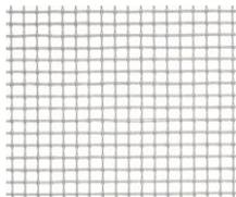
Das Glasfasergewebe ist zur Einbettung in den Unterputz, sowohl im Innen- und Außenputz, als auch im Vollwärmeschutzbereich geeignet. Es ist verschiebefest, alkalibeständig, alkohol- bzw. wasserfest und nach ETAG 004 zertifiziert (Reißfestigkeit Kette/Schuss (Auslieferungszustand) > 2.000 N/5cm).
