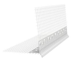
Das weiße PVC-Abschlussprofil mit beidseitigem VWS-Gewebe und Tropfkante dient zur Herstellung eines sauberen Tropfkantenabschlusses im WDVS Bereich. Durch die angeschrägten, gerillten Kanten und die Lochung im Profil wird die Haftung des Putzes verbessert. Nach dem Verputzen ist die Tropfkante teilweise noch sichtbar und sorgt für eine zuverlässige Wasserableitung.
