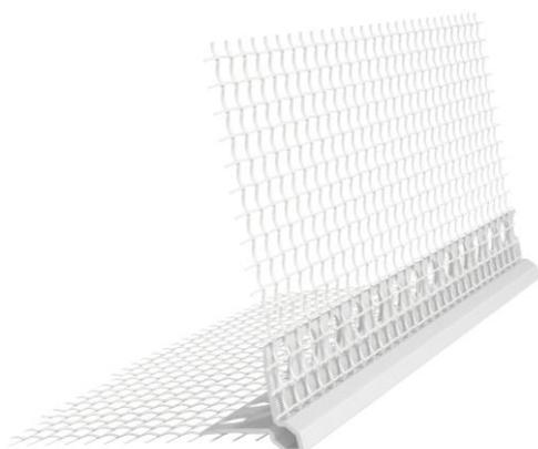
Das weiße, gelochte PVC-Profil mit geklebtem VWS-Gewebe und 10 mm Abzugskante eignet sich für Reibputze, zur Eckarmierung und Bildung von fluchtgerechten, stoßsicheren Kanten im Außenbereich. Durch die Lochung wird die Haftung des Putzes zum Grundmauerwerk verbessert.
