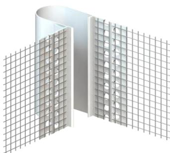
PVC-Profil mit co-extrudierter Dichtschlaufe aus Weich - PVC und verschweißtem VWS-Gewebe, beides mit 50 mm Überstand, zur Ausbildung von Dehnfugen.
