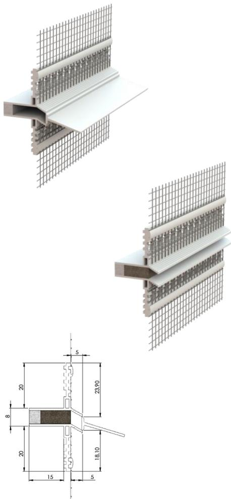
PVC-Profil mit Doppelabrisstreifen und verschweißtem VWS-Gewebe für flutgerechte und dauerhafte horizontale Bewegungsfugen in WDV-Systemen z.B. bei Aufstockungen.
