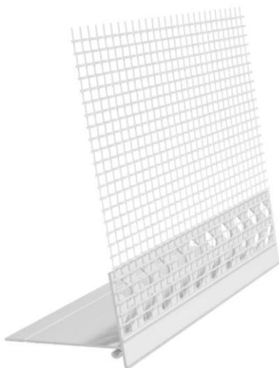
Das PVC-Sockelkantenprofil mit Tropfkante und Gewebe zum Einschieben dient als Abschlussprofil bei einer Fassadendämmung, die auf eine Perimeterdämmung aufgesetzt wird.
