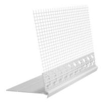
Das PVC-Sockelkantenprofil mit Tropfkante und Gewebe zum Einschieben dient als Abschlussprofil bei einer Fassadendämmung, die auf eine Perimeterdämmung aufgesetzt wird. Das Profil wird zwischen der Dämmstoffplatte und der Perimeterdämmung eingeschoben und mit einem PUR-Band bzw. einer PE-Rundschnur abgedichtet. Die Profile werden mittels Steckverbindung am Stoß verlängert.
