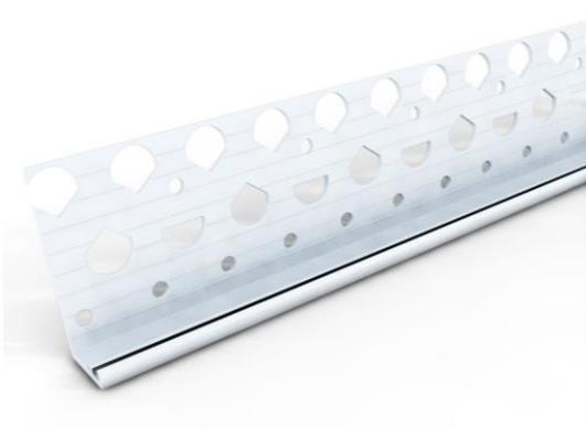
Das Profil wird über Türen, Fenstern und an der Sperrschicht eingesetzt, um einen bündigen Putzabschluss zu erzeugen. Die Tropfkante verhindert einen Wasserrückhalt, der eine Verfärbung des Sockelputzes verursachen kann.
