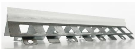
Das Kantenprofil besteht aus gelochtem und verzinktem Stahlblech mit spitzer, weißer PVC-Abzugskante, die für genaue und kaum sichtbare Kanten bei ein- und mehrlagigen Putze sorgt und vor Korrosion schützt.
