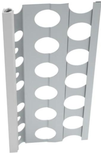
Das Kantenprofil besteht aus gelochtem und verzinktem Stahlblech mit weißem PVC-Überzug, der vor Abrieb und Korrosion schützt und wird z.B. im Laibungsbereich eingesetzt. Kantenprofile dienen dem Schutz und Stabilisierung der ECKAusbildung und sorgen gleichzeitig für exakte Kanten.
