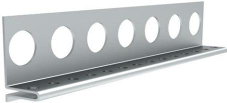
Das Profil wird in Verbindung mit 15 mm Gipskartonplatten im Trockenbau als Anschlussprofil zur Bildung von 4 mm Schattenfugen an angrenzende Flächen bzw. Bauteilen eingesetzt.
