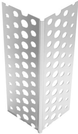
Das Kantenprofil besteht aus Aluminium und ist für Trockenbau bzw. dünne Putzschichten geeignet. Eckprofile für den Trockenbau dienen dem Schutz von Kanten und Ecken gegen mechanische Beschädigungen. Die Profile werden in verschiedenen Ausführungen und Materialien hergestellt. Profile müssen zur Plattenmitte hin verspachtelt werden.
