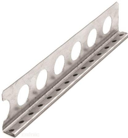
Das Abschlussprofil aus verzinktem Stahlblech wird im Trockenbau in Verbindung mit Gipskartonplatten eingesetzt. Es dient als Abschluss gegen andere Bauteile. Das Profil ist auf einer Seite gelocht, zur besseren Haftung in der Spachtelmasse und ist für 15 mm Gipskartonplatten geeignet.
