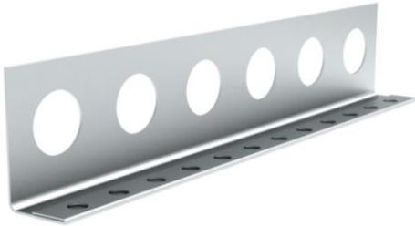
Das Abschlussprofil aus verzinktem Stahlblech wird im Trockenbau in Verbindung mit Gipskartonplatten eingesetzt. Es dient als Abschluss gegen andere Bauteile. Das Profil ist auf einer Seite gelocht, zur besseren Haftung in der Spachtelmasse und ist für 9,5 mm Gipskartonplatten geeignet.
