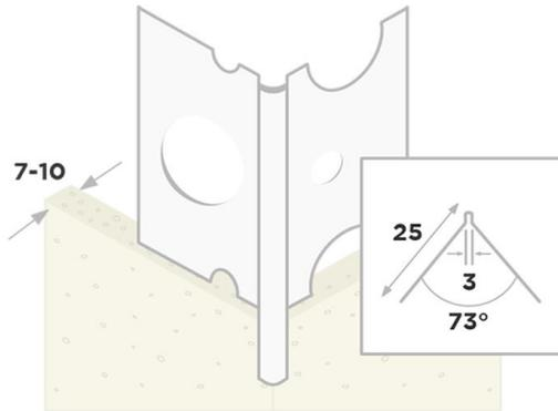
Das rundkantige Kantenrichtprofil mit kurzem Schenkel besteht aus durchgängig gelochtem, verzinkten Stahl und ist weiß beschichtet. Es dient als Kantenschutz für mechanisch stark beanspruchte Bereiche wie z.B. Mauerkanten und Fensterlaibungen und sorgt gleichzeitig für exakte Kanten.
