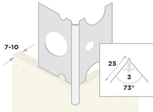
Das rundkantige Kantenrichtprofil mit kurzem Schenkel besteht aus durchgängig gelochtem und verzinktem Stahl. Es dient als Kantenschutz für mechanisch stark beanspruchte Bereiche wie z.B. Mauerkanten und Fensterlaibungen und sorgt gleichzeitig für exakte Kanten.
