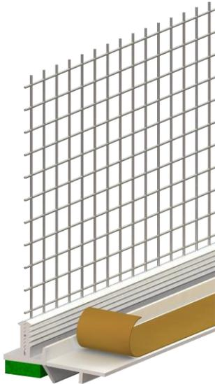
Selbstklebendes Dichtprofil zum Herstellen RAL-, ÖNORM- und SIA-Konformer Abdichtung der Bauanschlussfuge zwischen Fenster- bzw. Türelementen und dem Baukörper im Außenbereich für alle gängigen Wärmedämmverbundsysteme mit Armierungsspachtel und Edelputz. Ausgestattet mit grünem, schlagregendichten PE-Schaumband, TPE-Schutzlippe, verschweißtem VWS-Gewebe und hartem Abziehstreifen zur Aufnahme von Schutzfolien.
