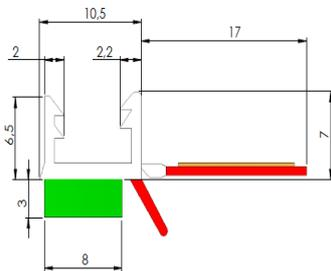
Selbstklebendes Dichtprofil zum Herstellen RAL-, ÖNORM- und SIA-konformer Abdichtung der Bauanschlussfuge zwischen Fenster- bzw. Türelementen und dem Baukörper im Außenbereich für alle gängigen Nassputzsysteme. Ausgestattet mit grünem, schlagregendichtem PE-Schaumband, TPE-Schutzlippe und flexiblem Abziehstreifen zur Aufnahme von Schutzfolien.
