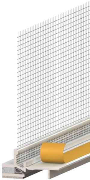
Selbstklebendes PVC-Profil, verbunden mit einer flexiblen TPE-Schlaufe,, um dreidimensionale Bewegungen aufnehmen zu können. Das Profil ist mit verschweißtem VWS-Gewebe, einem schlagregendichten PE-Dichtband sowie einem flexiblen Übergang zum Abziehstreifen zur Aufnahme von Schutzfolien ausgestattet.
