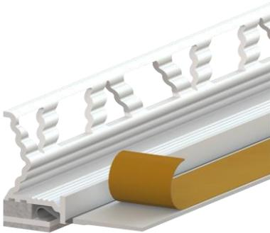
Selbstklebendes PVC Profil, verbunden mit einer flexiblen TPE-Schlaufe, um dreidimensionale Bewegungen aufnehmen zu können. Das Profil ist mit einem schlagregendichten PE-Dichtband sowie einem flexiblen Übergang zum Abziehstreifen zur Aufnahme von Schutzfolien ausgestattet.
