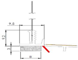
Selbstklebendes Laibungsanschlussprofil zum Herstellen der Putzanschlüsse zwischen Fenster- und Türelementen und allen gängigen Wärmedämmverbundsystemen mit Armierungsspachtel und Edelputz. Ausgestattet mit weißem, schlagregendichtem PE-Schaumband, TPE-Schutzlippe, verschweißtem VWS-Gewebe und hartem Abziehstreifen zur Aufnahme von Schutzfolien. Das Profil & die Schutzlippe sind anthrazit, ähnlich RAL 7016.
