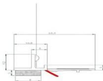
Selbstklebendes Laibungsanschlussprofil zum Herstellen der Putzanschlüsse zwischen Fenster- und Türelementen und allen gängigen Wärmedämmverbundsystemen mit Armierungspachtel und Edelputz. Ausgestattet mit weißem, schlagregendichtem PE-Schaumband, TPE-Schutzlippe, verschweißtem VWS-Gewebe und hartem Abziehstreifen zur Aufnahme von Schutzfolien.
