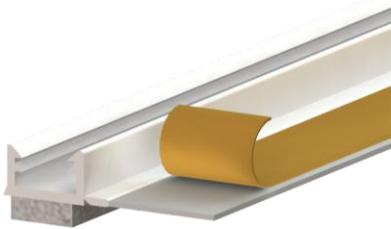
Selbstklebendes Laibungsanschlussprofil zum Herstellen der Putzanschlüsse im Innen- und Außenbereich für alle gängigen Nassputzsysteme. Ausgestattet mit weißem, schlagregendichtem PE-Schaumband und hartem Abziehstreifen zur Aufnahme von Schutzfolien. Die Profile sind geeignet sowohl für Bauelemente aus Kunststoff, Aluminium und Holz (mindestens grundiert) als auch für Holzständerbauweise und Massivmauerwerk.
