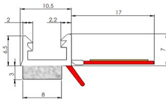
Selbstklebendes Laibungsanschlussprofil zum Herstellen der Putzanschlüsse im Innen- und Außenbereich bei Massivmauerwerk für alle gängigen Nassputzsysteme. Ausgestattet mit weißem, schlagregendichtem PE-Schaumband, TPE-Schutzlippe und flexiblem Abziehstreifen zur Aufnahme von Schutzfolien.
