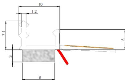
Selbstklebendes Laibungsanschlussprofil zum Herstellen der Putzanschlüsse im Innen- und Außenbereich für alle gängigen Nassputzsysteme. Ausgestattet mit weißem, schlagregendichtem PE-Schaumband, TPE-Schutzlippe und hartem Abziehstreifen zur Aufnahme von Schutzfolien.
