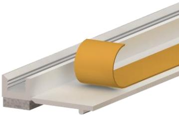
Selbstklebendes Laibungsanschlussprofil zum Herstellen der Putzanschlüsse im Innenbereich für alle gängigen Nassputzsysteme. Ausgestattet mit weißem, schlagregendichtem PE-Schaumband und hartem Abziehbstreifen zur Aufnahme von Schutzfolien. Die Profile sind geeignet sowohl für Bauelemente aus Kunststoff, Aluminium und Holz (mindestens grundiert) als auch für Holzständerbauweise und Massivmauerwerk.
