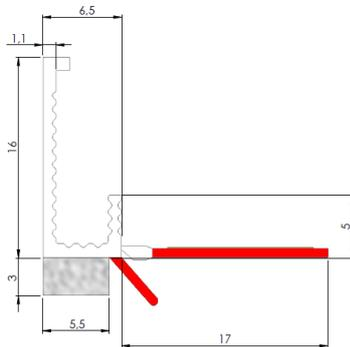
Selbstklebendes Laibungsanschlussprofil zum Herstellen der Putzanschlüsse im Innen- und Außenbereich für alle gängigen Nassputzsysteme. Ausgestattet mit weißem, schlagregendichtem PE-Schaumband, TPE-Schutzlippe, gelochtem Einputzschenkel und flexiblem Abziehstreifen zur Aufnahme von Schutzfolien.
