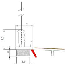
Selbstklebendes Laibungsanschlussprofil zum Herstellen der Putzanschlüsse zwischen Fenster- und Türelementen und allen gängigen Wärmedämmverbundsystemen mit Armierungsspachtel und Edelputz. Ausgestattet mit weißem, schlagregendichtem PE-Schaumband, TPE-Schutzlippe, verschweißtem VWS-Gewebe und hartem Abziehstreifen zur Aufnahme von Schutzfolien.
