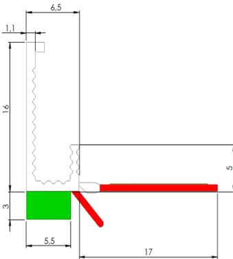
Selbstklebendes Dichtprofil zum Herstellen RAL-, ÖNORM- und SIA-konformer Abdichtung der Bauanschlussfuge zwischen Fenster- bzw. Türelementen und dem Baukörper im Außenbereich für alle gängigen Nassputzsysteme.
