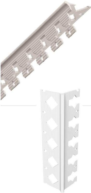
Profile für den Trockenbau werden für Spachtelarbeiten in Verbindung mit Gipskartonplatten verwendet und schützen Ecken und Kanten vor mechanischen Beschädigungen.
