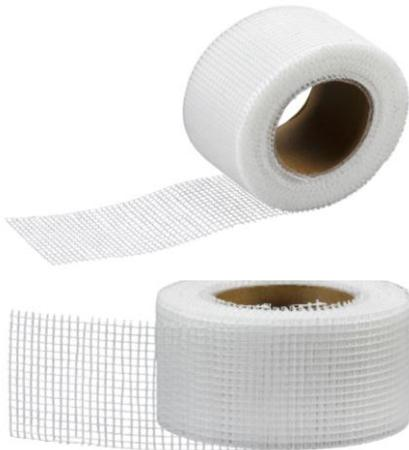
Selbstklebende Fugenstreifen, weiß, aus Glasfasergewebe, dienen der Überbrückung bzw. Vermeidung von Rissen im Mauerwerk und bei Spachtelarbeiten in Verbindung mit Gipskartonplatten.
