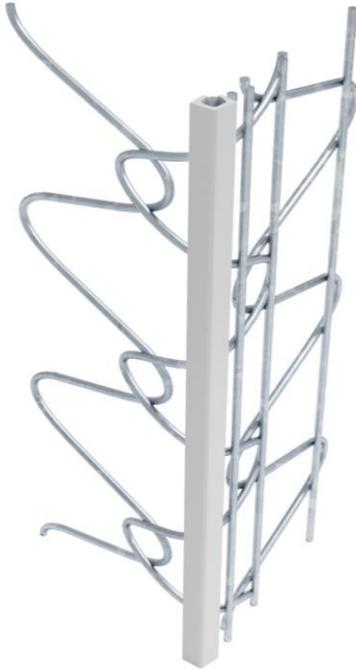
Der Drahtrichtwinkel ist ein Winkel aus verzinktem Draht, der an diversen Stellen punktgeschweißt und miteinander verbunden ist. Durch die nur geringe Berührung der Drähte ermöglicht er eine hohe Putzdurchlässigkeit und eine optimale Armierung der Kanten. Somit lässt sich der Drahtrichtwinkel vollständig mit dem Grundputz ausspritzen, ermöglicht einen maximalen Mörteldurchgriff und sorgt somit für eine hohe Stabilität an Ecken und Kanten.
