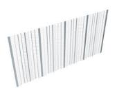
Das Rippenstreckmetall besteht aus verzinktem Stahlblech, produziert nach BS EN 10349:2009 –DX51D+Z275, und lässt sich nicht nur im Putzbereich, sondern auch im Beton- und Stahlbau vielseitig einsetzen. Dieses Streckmetall ist für den Einsatz im Wand-, jedoch nicht im Deckenbereich geeignet.
