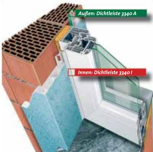
**1** Das Dichtsystem bietet für innen und außen optimierte Profile. Die farbliche Kennzeichnung verhindert das unabsichtliches Vertauschen.
