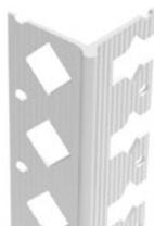
**PVC Rundbogenprofil für Trockenbau bzw. dünne Putzstärken. Zum Ausformen von Bögen mit einem Radius von mind. 250 mm. Anbringung durch Heft-, Nagel-, Spachtel- oder Klebetechnik.**
