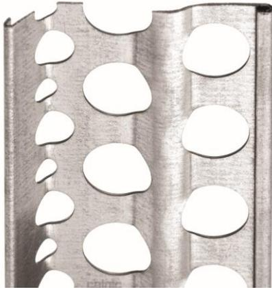
Diese Putzabschlussprofile bestehen aus gelochtem und verzinktem Stahl. Sie werden zur Abgrenzung zu anderen Bauteilen, Werkstoffen oder Bodenbelägen oder auch zur Fugenausbildung eingesetzt. Das Abschlussprofil 4202 ist für unterschiedliche Putzstärken zwischen Wandflächen und Laibungen verwendbar.
