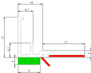
Selbstklebendes Dichtprofil zum Herstellen RAL-, ÖNORM- und SIA-konformer Abdichtung der Bauanschlussfuge zwischen Fenster- bzw. Türelementen und dem Baukörper im Außenbereich für alle gängigen Nassputzsysteme. Ausgestattet mit grünem, schlagregendichtem PE-Schaumband, TPE-Schutzlippe, gelochtem Einputzschenkel und flexiblem Abziehstreifen zur Aufnahme von Schutzfolien.
