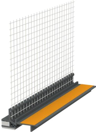
Selbstklebendes PVC-Profil, verbunden mit einer flexiblen TPE-Schlaufe,, um dreidimensionale Bewegungen aufnehmen zu können. Das Profil ist mit verschweißtem VWS-Gewebe, einem schlagregendichten PE-Dichtband sowie einem flexiblen Übergang zum Abziehstreifen zur Aufnahme von Schutzfolien ausgestattet. Das Profil & die Schutzlippe sind anthrazit, ähnlich RAL 7016.
