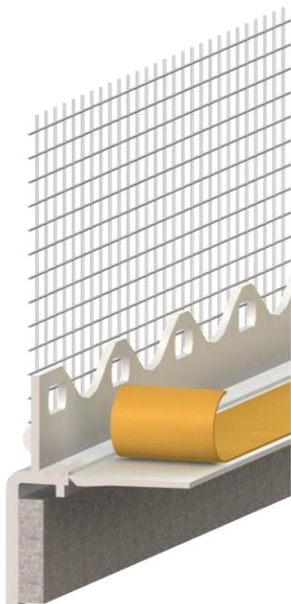
Selbstklebendes PVC Profil für seitliche Anschlüsse an Vorbaurollläden. Das Profil ist mit verschweißtem VWS-Gewebe, einem schlagregendichten PE-Dichtband sowie einem harten Abziehstreifen zur Aufnahme von Schutzfolien ausgestattet.
